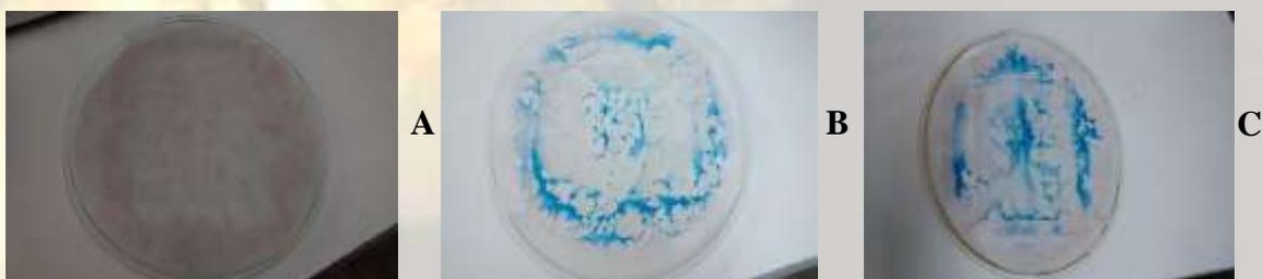
**Figura 1.** Mapeamento por secagem da solução aquosa de CoCl<sub>2</sub>: (A) antes da irradiação das micro-ondas; (B) após irradiação com prato giratório e (C) após irradiação com prato fixo. **Fonte:** Dados da Pesquisa.
